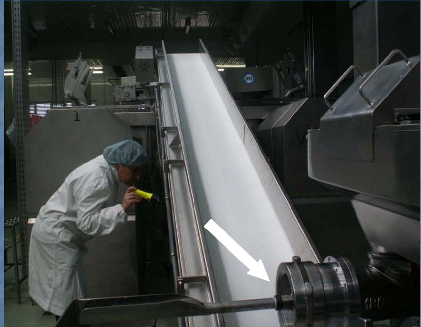
*In queste sequenze si noti come del grasso lubrificante utilizzato nella macchina a fine ciclo sia poi caduto sul nastro trasportatore. L'esecuzione delle SSOP preoperative nell'immediatezza dell'attività lavorativa consente di prevenire pericoli derivanti da contaminazioni delle superfici successivamente al lavaggio.*
